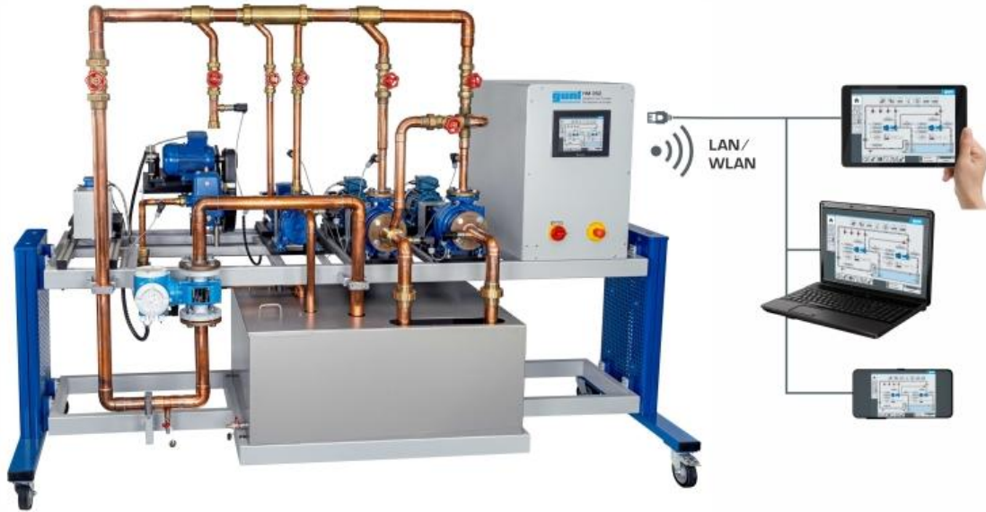
Stand pentru determinarea caracteristicii cuplajului a două pompe centrifuge în paralel sau în serie.
