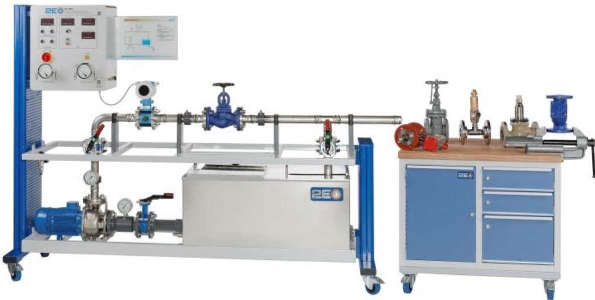
Stand pentru determinarea pierderilor de sarcină în instalațiile cu tubulaturi RT 396
